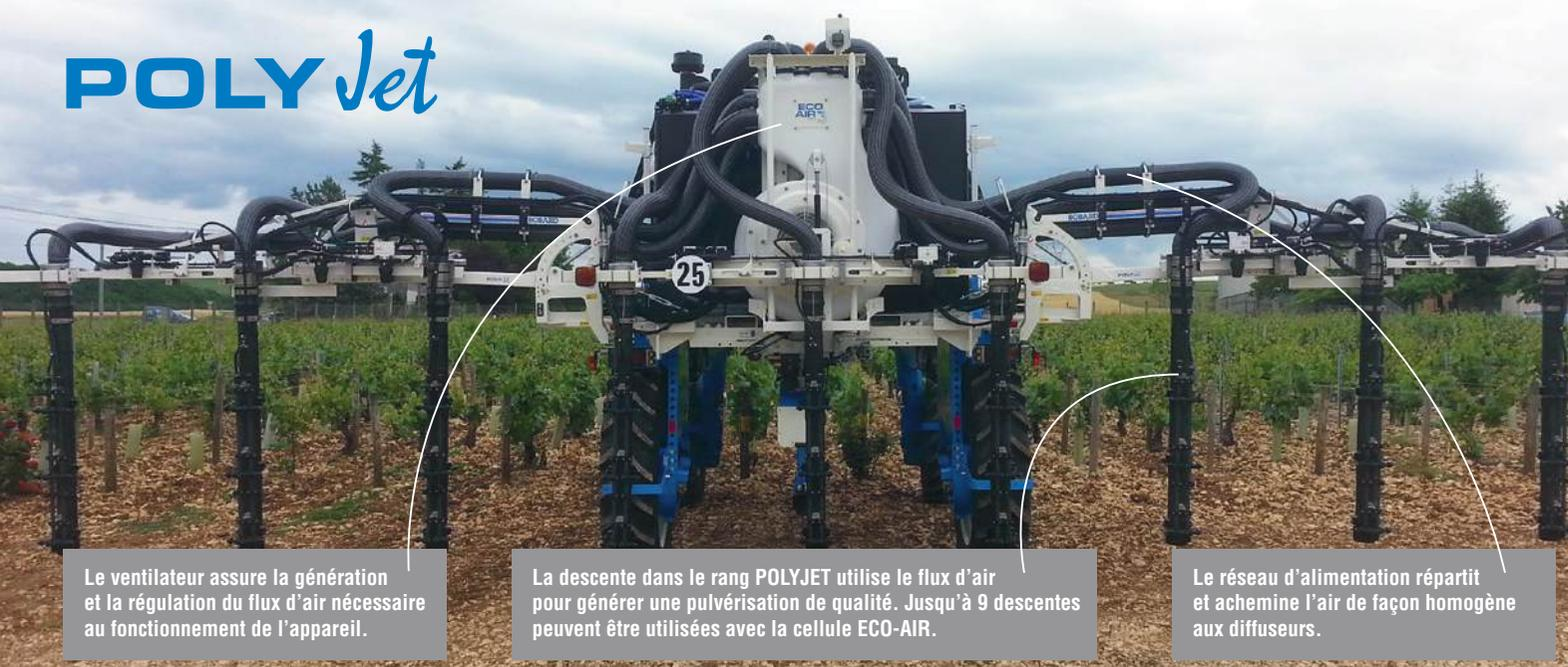
Le ventilateur assure la génération et la régulation du flux d'air nécessaire au fonctionnement de l'appareil.
